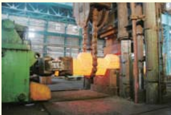
▲ 鞍钢成功锻造出AP1000核电站主管道锻件
